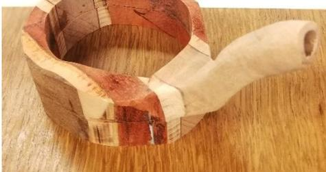
J'ai également tracé la future perce du trou par le bec et la sortie dans le bas de cuve.
